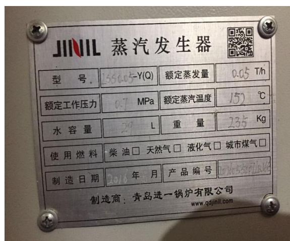
蒸汽发生器铭牌
